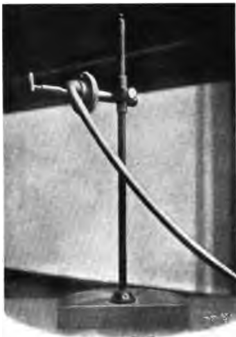
APPARELHO DE KOENIG PARA PHOTOGRAPHAR AS VIBRAÇÕES DA FALA
