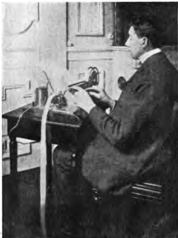
ESCREVENDO UM DESPACHO PARA TRANSFERENCIA PELA MACHINA TELEGRAPHICA POLLAK E VIRAG
